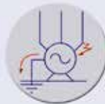
Protección defecto a tierra
